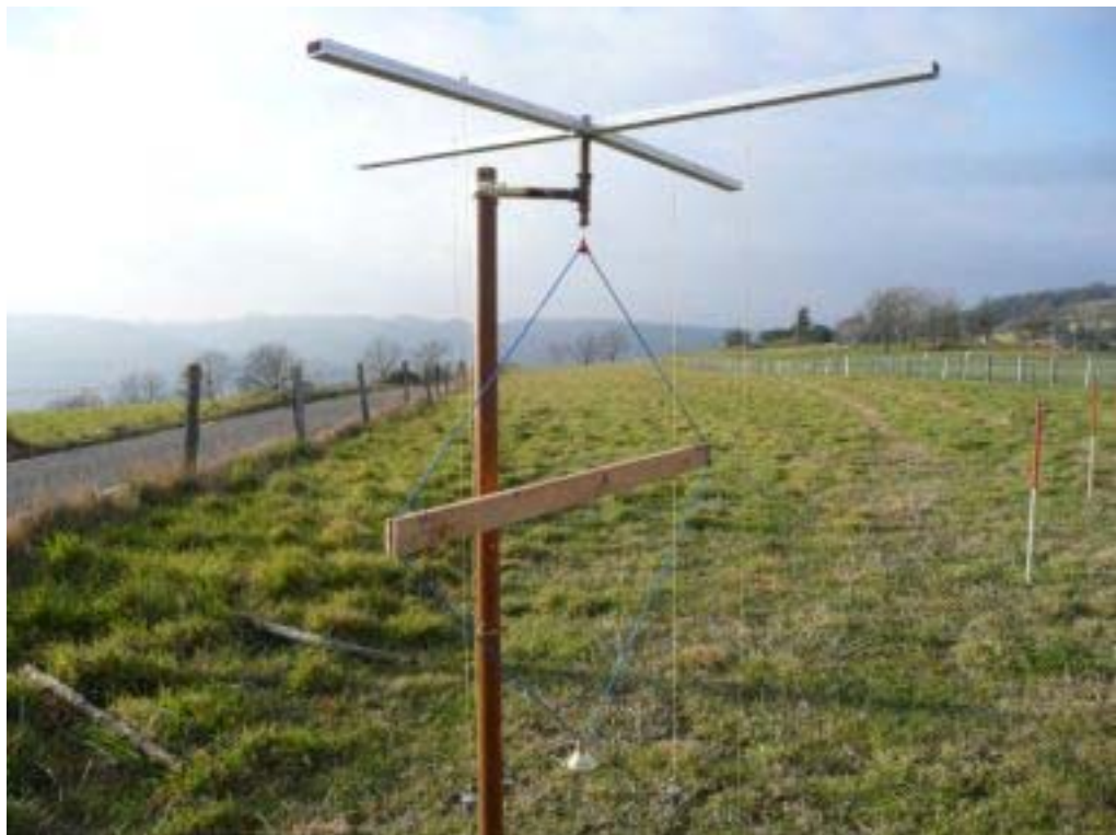
Fig. 7. "Libella" restituée par Joseph Barou du GAFJ, en position sous une groma.
